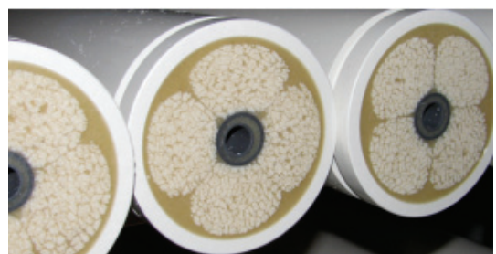
Abbildung 4: Ultrafiltrationselemente mit mehr als 1.000 Hohlfasern pro Filter in der Produktion
